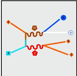
I **quark** risultati dalla collisione dei nuclei, possono interagire ed emettere **bosoni**, di cui uno decade in più **quark**, e l'altro decade in un **muone** ed un **neutrino muonico**. Nel rivelatore, i **quark** formano **jet** nei calorimetri. I
