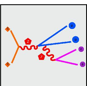
Una coppia di **quark** scompare e si forma un **bosone Z**, il quale decade in una **coppia di muoni**, ed una coppia di **elettroni**. Nel rivelatore, gli
