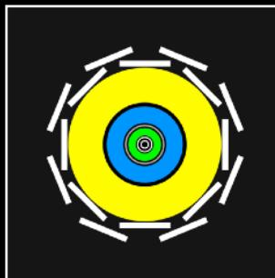
Nos pontos de colisão, existem detetores enormes (semelhantes a câmaras 3D gigantescas) para analisar as partículas produzidas. Vemos aqui cortes longitudinais e transversais do **detetor ATLAS**. A partir do centro, **detectores de traços** registam a trajetória das partículas carregadas; o íman
